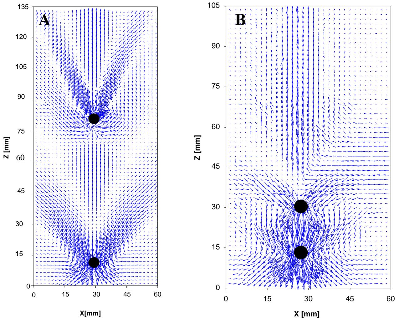
Figure 1 : Champ de vitesse autour de deux sphères en sédimentation dans une solution de PAAm dans l'eau à 1% en masse. A : vitesse de la sphère de tête :  $U_t = 0,108 \text{ m/s}$ , vitesse de la sphère de queue :  $U_q = 0,105 \text{ m/s}$ . B : vitesse de la sphère de tête :  $U_t = 0,099 \text{ m/s}$ , vitesse de la sphère de queue :  $U_q = 0,132 \text{ m/s}$ .
